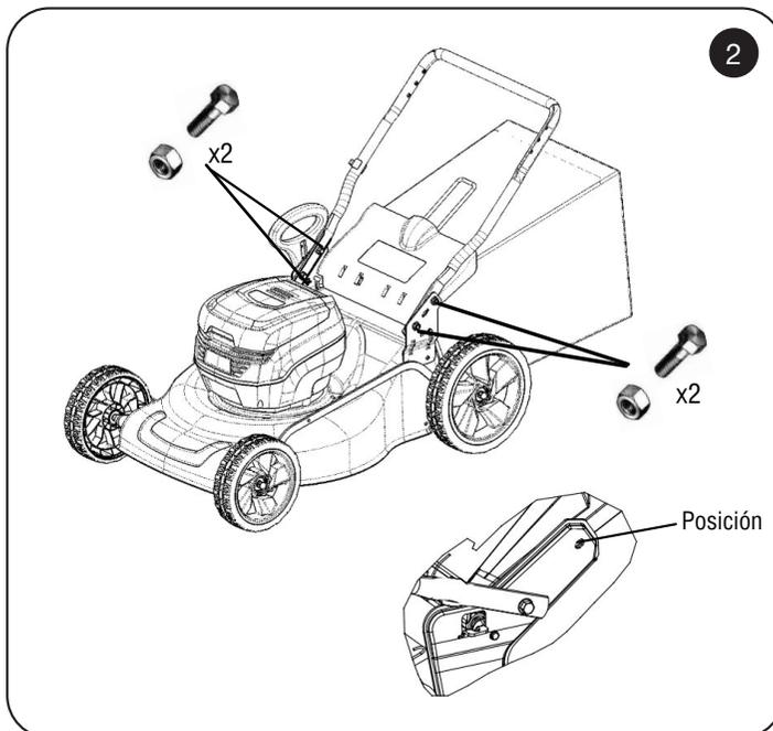
**Nota:** Asegúrese de que ambos lados estén colocados en la misma posición para un ensamblaje adecuado.
