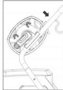
**5.** Conectar la tubería de alta presión.
