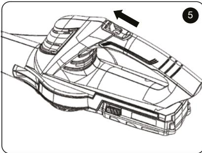
» Para apagar el soplador, deslice el interruptor de encendido/apagado hacia atrás como se muestra en la **Figura 6**.
